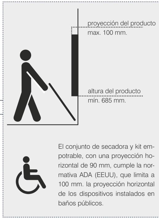
El conjunto de secadora y kit empotable, con una proyección horizontal de 90 mm, cumple la normativa ADA (EEUU), que limita a 100 mm. la proyección horizontal de los dispositivos instalados en baños públicos.
